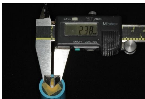
รูปที่ 5 : ภาพแสดงเทปกาวที่ถูกเจาะรูขนาดเส้นผ่านศูนย์กลาง 2.38 mm
