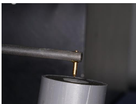
รูปที่ 4 : แสดงการวัดความหยาบพื้นผิวด้วยเครื่องวัดความหยาบพื้นผิว (Talyscan 150, England)
