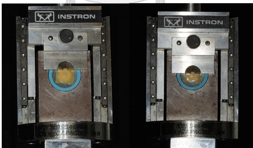
รูปที่ 8: แสดงกระบวนการทดสอบกำลังแรงยึดเหนี่ยว
