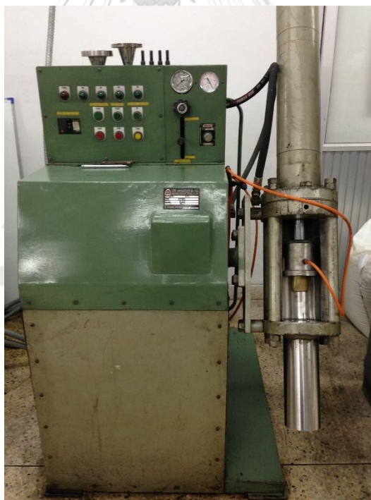
รูปที่ 3.3 เครื่องอัดรีดแบบ Ram type
