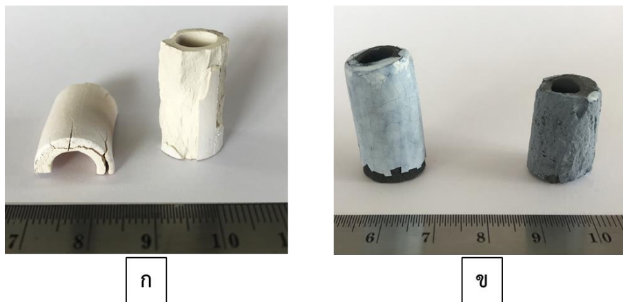
รูปที่ 4.51 ตัวอย่างลักษณะการหลุดล่อนของผิวเคลือบหลังเผา บนชิ้นงานวัสดุเซรามิกประกอบสูตร (ก)FBC01 และ (ข) FBC02
