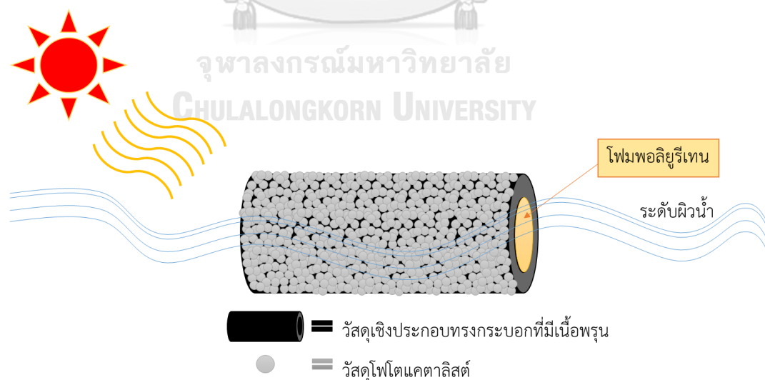
รูปที่ 3.1 การลอยน้ำของวัสดุเชิงประกอบทรงกระบอกที่มีเนื้อพรุนเคลือบด้วยวัสดุโฟโตแคตาไลสต์
