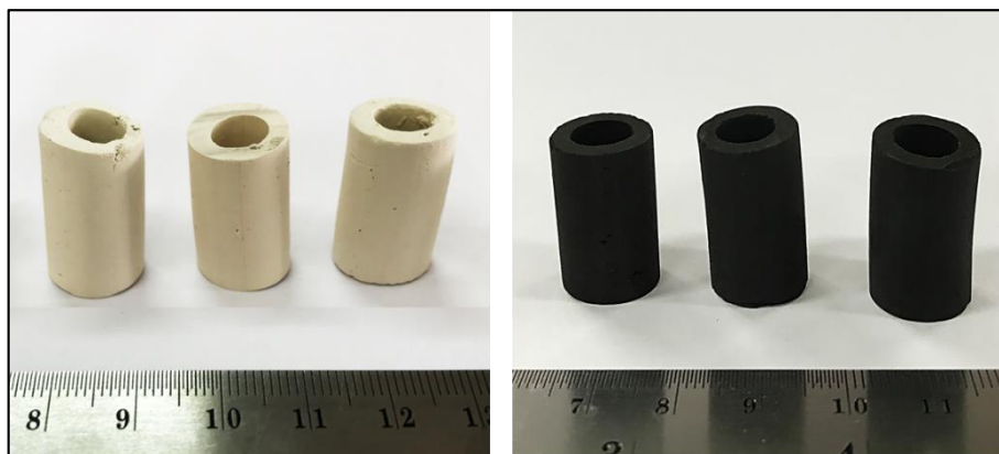
รูปที่ 4.34 ลักษณะชิ้นงานวัสดุเชิงประกอบทรงกระบอกที่มีเนื้อพรุนเพื่อใช้เป็นตัวรองรับสำหรับ เคลือบวัสดุโฟโตแคตาลิสต์หลังเผาที่ 650 องศาเซลเซียส สูตร (ก) FBC01 และ (ข) FBC02
