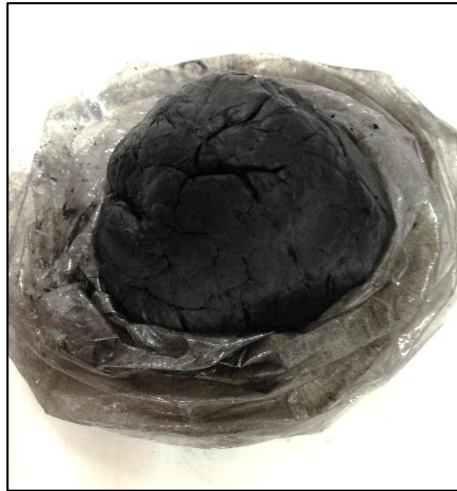
รูปที่ 4.11 เนื้อโตะของส่วนผสมก่อนขึ้นรูปด้วยการอัดรีด
