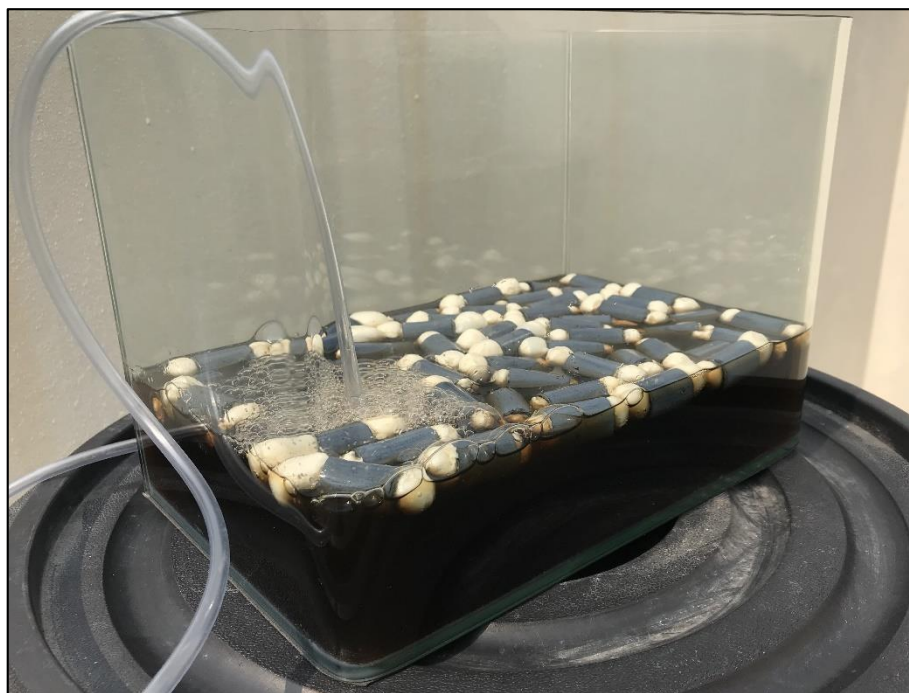
รูปที่ 4.60 การทดสอบประสิทธิภาพการลดความเข้มข้นของน้ำทิ้งที่ผ่านการบำบัดของโรงงานน้ำมันปาล์มด้วยวัสดุเชิงประกอบทรงกระบอกพรุนเคลือบด้วยวัสดุโฟโตแคตตาลิสต์เชิงประกอบไทเทเนียมไดออกไซด์/ไฟไรต์ ภายใต้แสงจากดวงอาทิตย์
