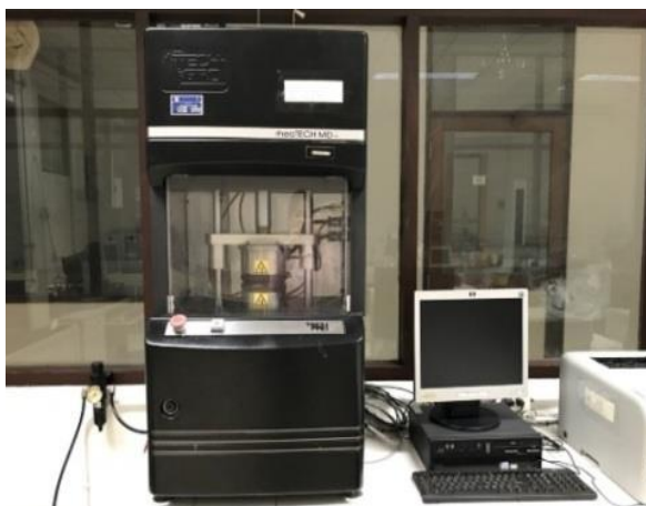
รูปที่ 3.10 เครื่องวิเคราะห์พฤติกรรมกรรมการบ่ม
