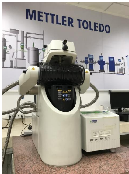
รูปที่ 3.15 เครื่องวิเคราะห์สมบัติเชิงกลพลวัต
