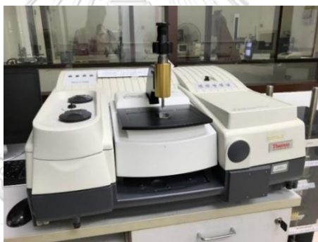
รูปที่ 3.2 เครื่องฟูเรียร์ทรานสฟอร์มอินฟราเรดสเปกโตรมิเตอร์
