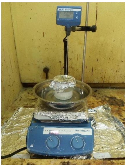
รูปที่ 3.1 อุปกรณ์ที่ใช้สังเคราะห์ยาง ENR
