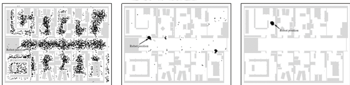
รูปที่ 2.16 การทำงานของ Particle Filter ในระนาบสองมิติ [13]
