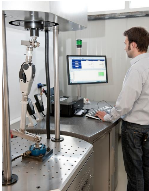
รูปที่ 6. 7 แสดงการติดตั้งเข้าเพื่อทดสอบความแข็งแรงตามมาตรฐาน ISO 10328 บนเครื่องทดสอบ โดยทำดังกล่าวคือทำ Toe off
