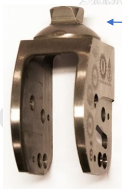
รูปที่ 4. 3 ชิ้นส่วนกลไกหลักด้านบนรุ่นแรกของห้องวิจัยที่ถูกตัดบริเวณด้านหน้าออก
