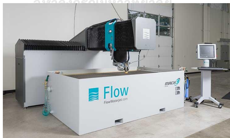
รูปที่ 5. 22 เครื่อง Waterjet สำหรับตัดสปริง Stance flexion และ Swing flexion
