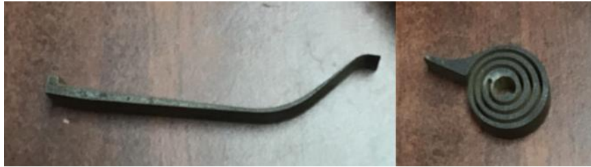
รูปที่ 5. 23 สปริง Stance flexion (รูปซ้าย) และ Swing flexion (รูปขวา) ที่ถูกตัดด้วยเครื่อง Waterjet
