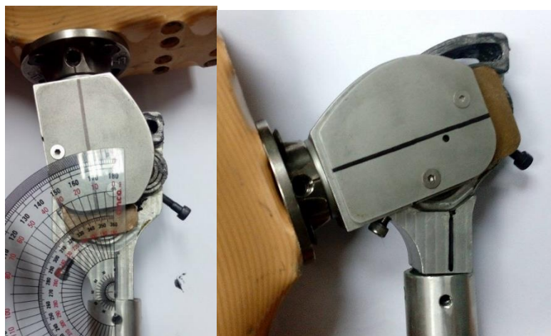
รูปที่ 4. 4 (ด้านซ้าย)แสดงมุมมองของ Stance flexion สูงสุดที่ 10 องศา (ด้านขวา)แสดงท่าทางที่มุมมากกว่า 90 องศา
