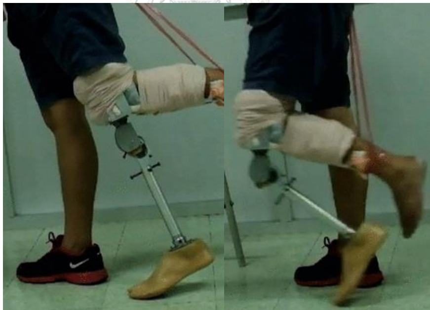
รูปที่ 4. 16 การทดสอบที่ละท่า ในท่า Swing flexion กลไกเกิดการพับงอเข้ากลไก Swing flexion ทั้งนี้หลักจาก Toe off
