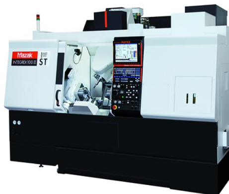
รูปที่ 5. 19 เครื่อง CNC ยี่ห้อ Mazak รุ่น Integrex 100-IV st ที่ใช้ทำการกัดชิ้นส่วนกลไกหลักทั้งบน และล่าง
