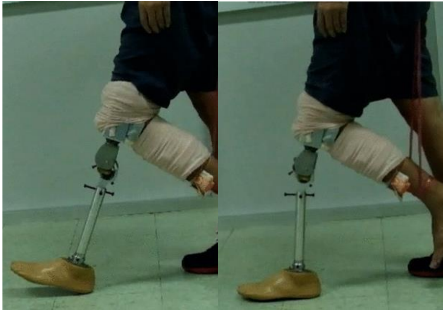
รูปที่ 4. 15 การทดสอบที่ละท่า ในท่า Stance flexion กลไกเกิดการพับงอเข้ากลไก Stance flexion ทั้งนี้หลักจาก Heel strike
