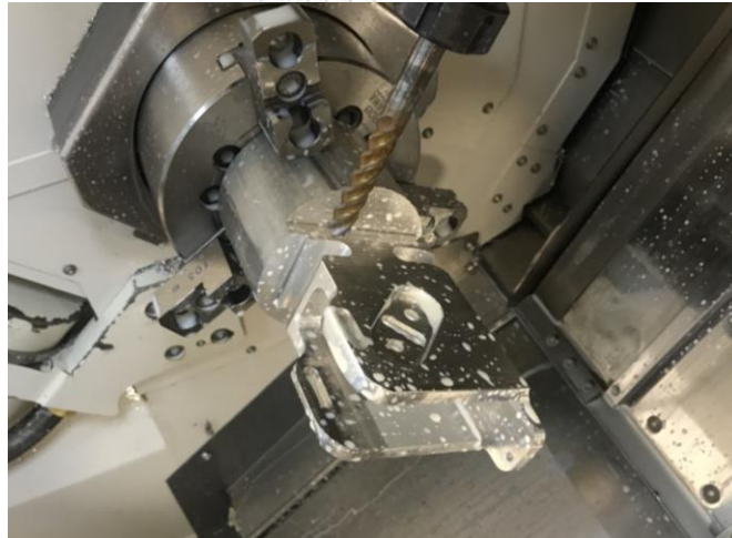
รูปที่ 5. 21 ชิ้นส่วนหลักด้านบนบนขณะขึ้นรูปชิ้นงานด้วยเครื่อง CNC
