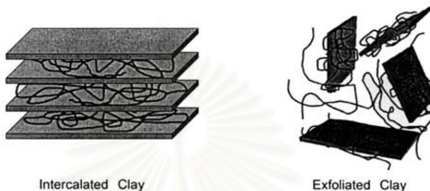
รูปที่ 2.4 โครงสร้างของ organoclay
