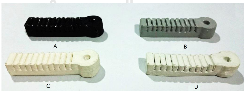
รูปที่ 22 นิ้วมือแบบยึดหยุ่นจากการพิมพ์ 3 มิติแบบเต็มชิ้น จำนวน 4 วัสดุ A.ซิลิโคน, B. โพลียูรีเทน, C. Silicone Rubber Mixture และ D. ยาง
