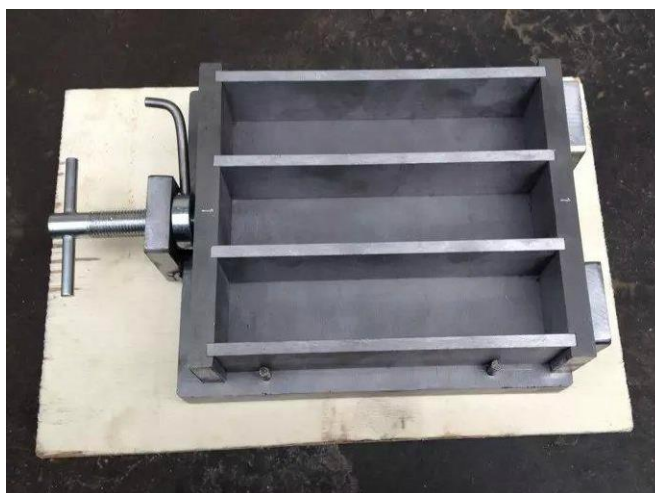
รูปที่ 16 แม่พิมพ์ที่ใช้ในการหล่อมอร์จาร์ขนาด 40x40x160 มม.
