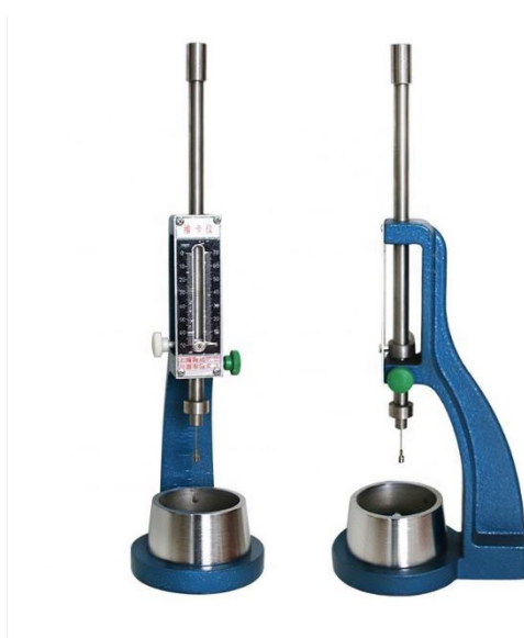
รูปที่ 15 เข็มของไวแคต (Vicat needle)
