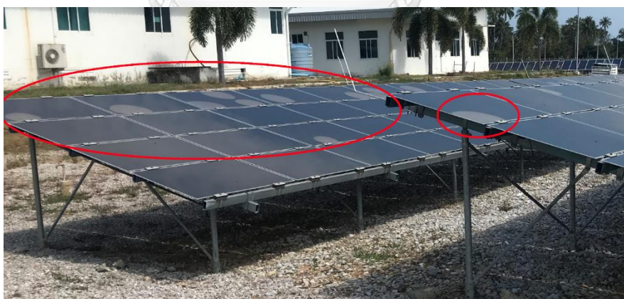
รูปที่ 19 การเกิดฟองอากาศบนแผงโซลาร์เซลล์ในโซน A(CIGS)
