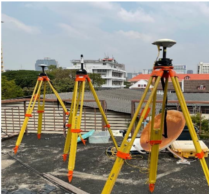
รูปที่ 16 การรับสัญญาณดาวเทียมแบบสถิตทั้งหมด SV1 SV2 SV3 ตามลำดับจากซ้ายไปขวา วันที่ 26-29 มกราคม 2564
