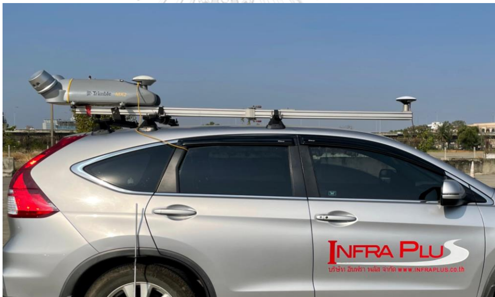
รูปที่ 9 การติดตั้งเสาอากาศรับสัญญาณดาวเทียมบนราวเหล็กหลังคารถยนต์
