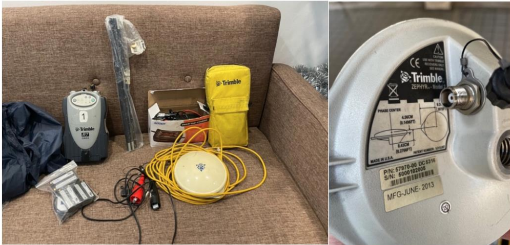
รูปที่ 8 อุปกรณ์รับสัญญาณ Trimble R7 และ Antenna Zephyr model 2
