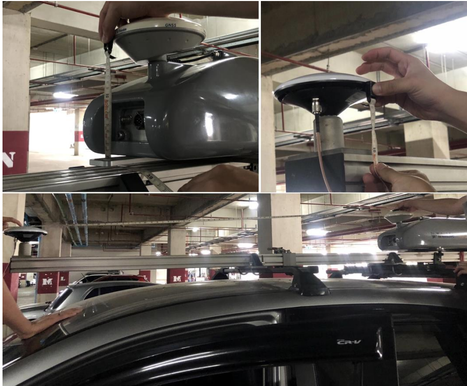
รูปที่ 21 ตรวจสอบค่าขดเชยระยะของเสาอากาศที่ติดตั้งบนหลังคารถยนต์
