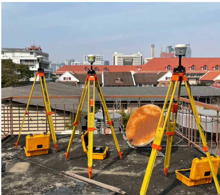
รูปที่ 15 การรังวัดสัญญาณดาวเทียมแบบสถิตเพื่อหาค่าพิกัดหมุดอ้างอิงด้วย CHC i80 บริเวณ ดาดฟ้าอาคารศาลิวิธานนิเทศ (ตึกวิศวกรรมสำรวจ) วันที่ 21 มกราคม 2564
