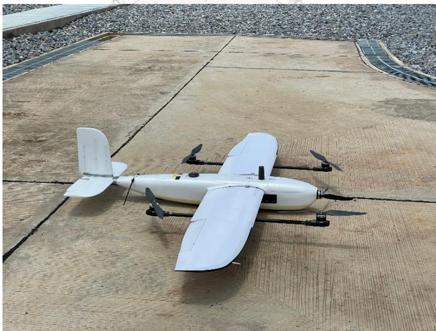
รูปที่ 19 อากาศยานไร้คนขับ Loong VTOL ติดตั้งอุปกรณ์รับสัญญาณ GNSS U-blox F9P พร้อมเสาอากาศประเภท Helical
