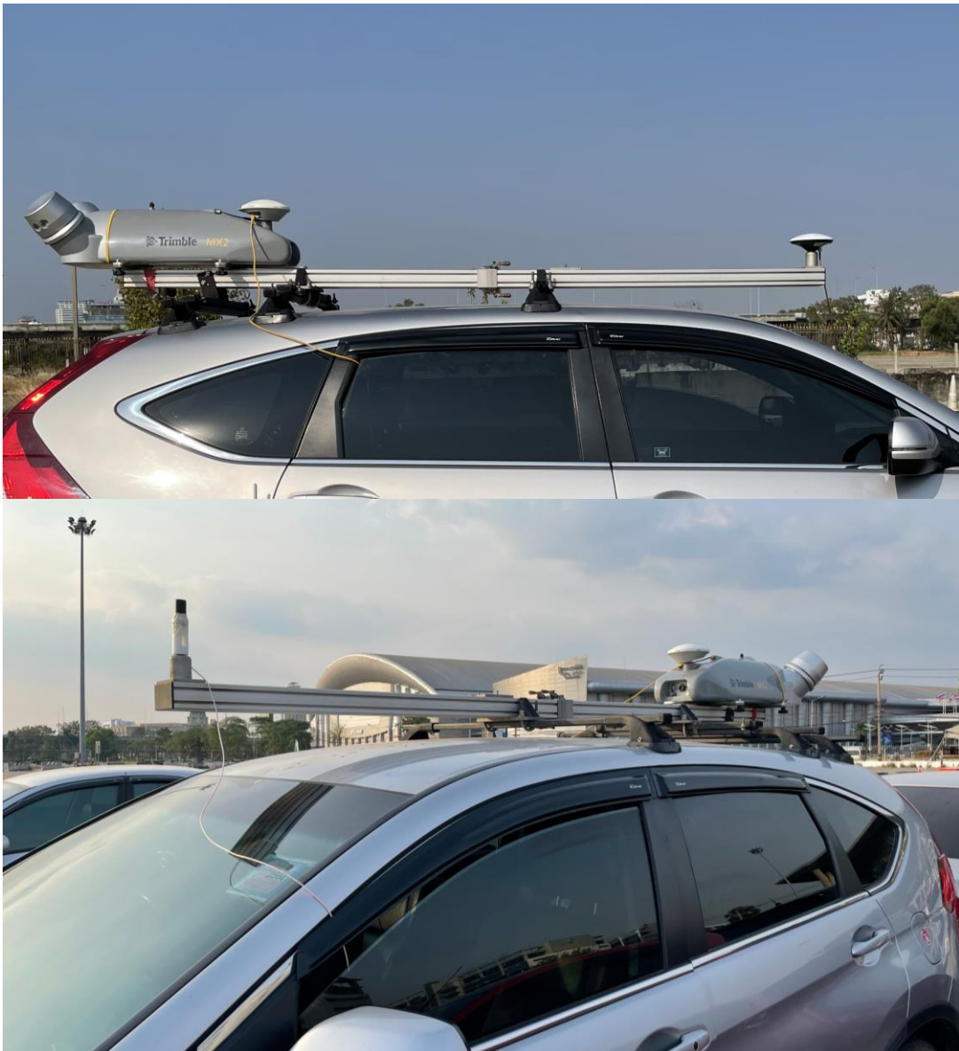
รูปที่ 18 การติดตั้งอุปกรณ์บนราวหลังคารถยนต์เพื่อทำการรังวัดแบบจลน์
