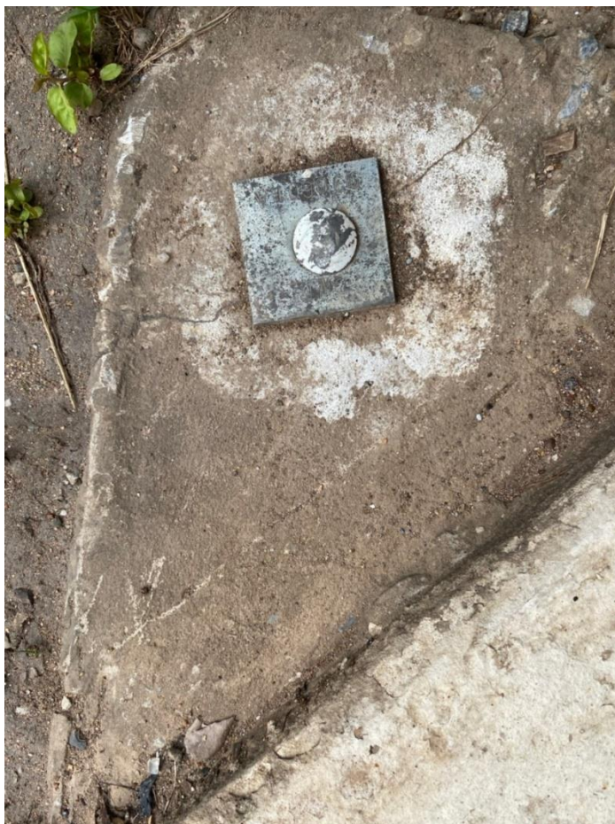
รูปที่ 13 แสดงหมุดควบคุมทางระดับและพิกัด
