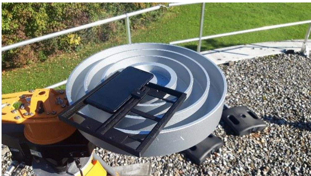
รูปที่ 7 แสดงสมาร์ทโฟนและ choke ring platform ที่ถูกติดตั้งพร้อมรับสัญญาณ (Sharma et al., 2020)
