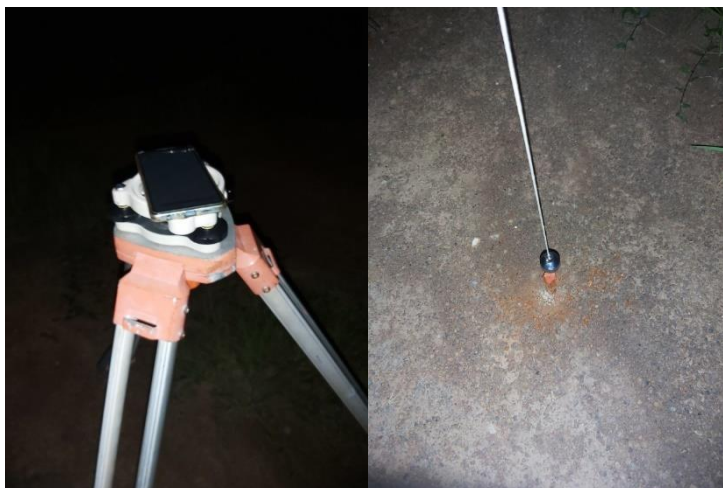
รูปที่ 21 แสดงการเตรียมอุปกรณ์ก่อนลงสำรวจโดยใช้สมาร์ทโฟน
