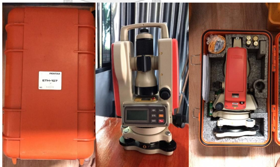
รูปที่ 2 แสดงกล้อง Electronic Theodolite รุ่น PENTAX ETH-107
