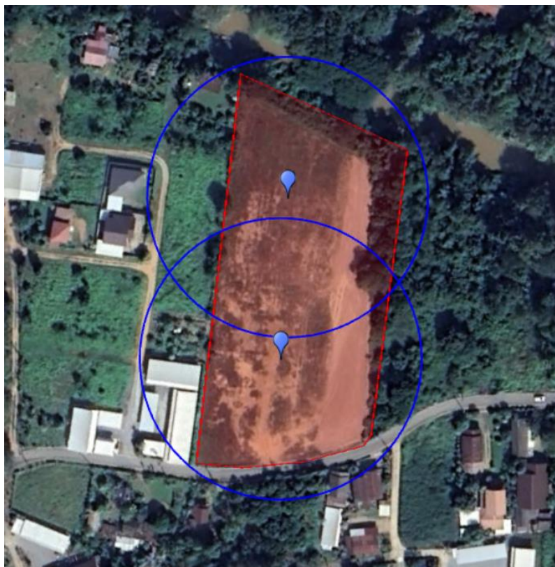
รูปที่ 16 แสดงตำแหน่งหมุดควบคุมชั่วคราวทั้ง 2 หมุด
