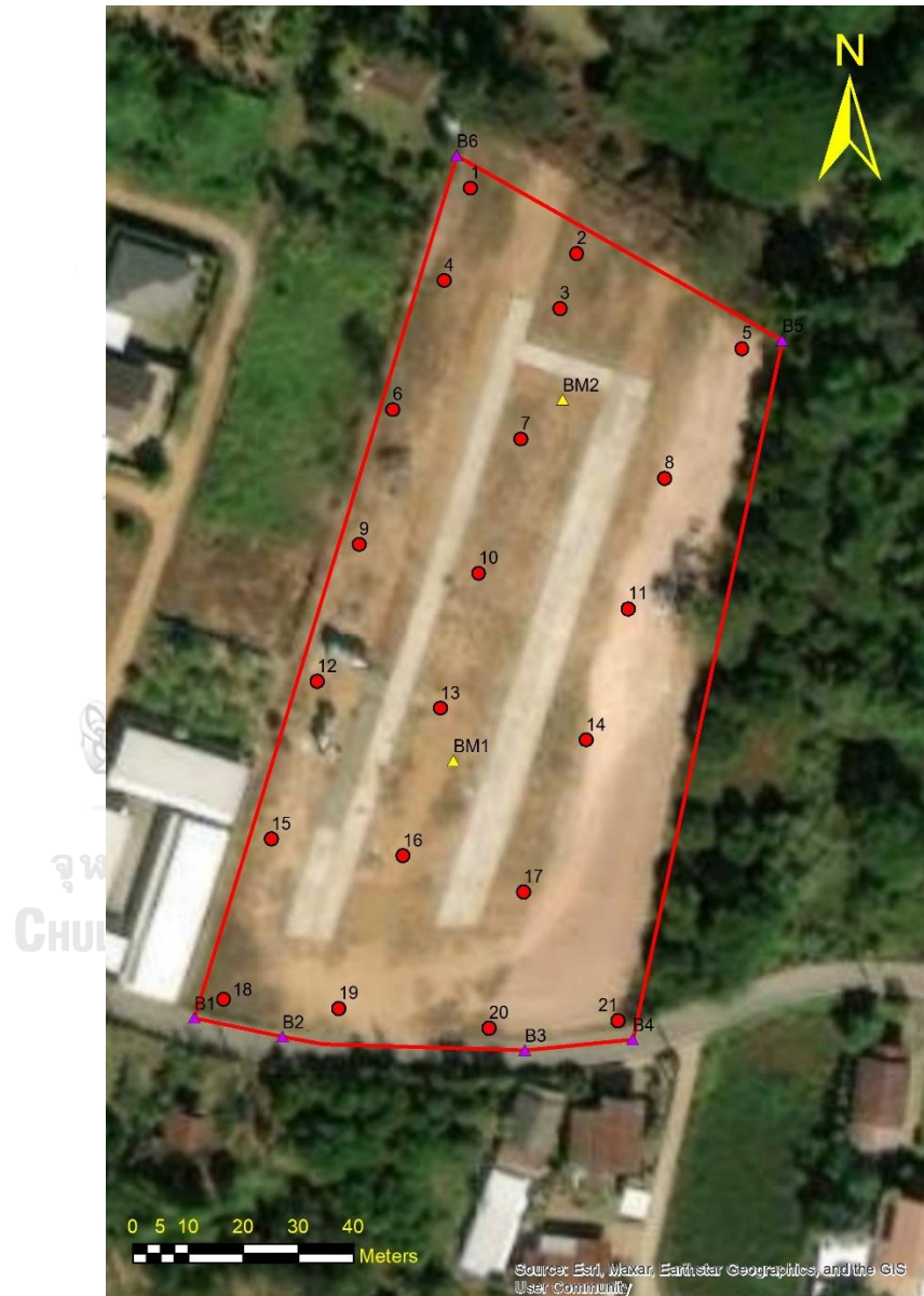
รูปที่ 27 แสดงตำแหน่งหมุดควบคุมชั่วคราวและหมุดทดสอบบน google earth
