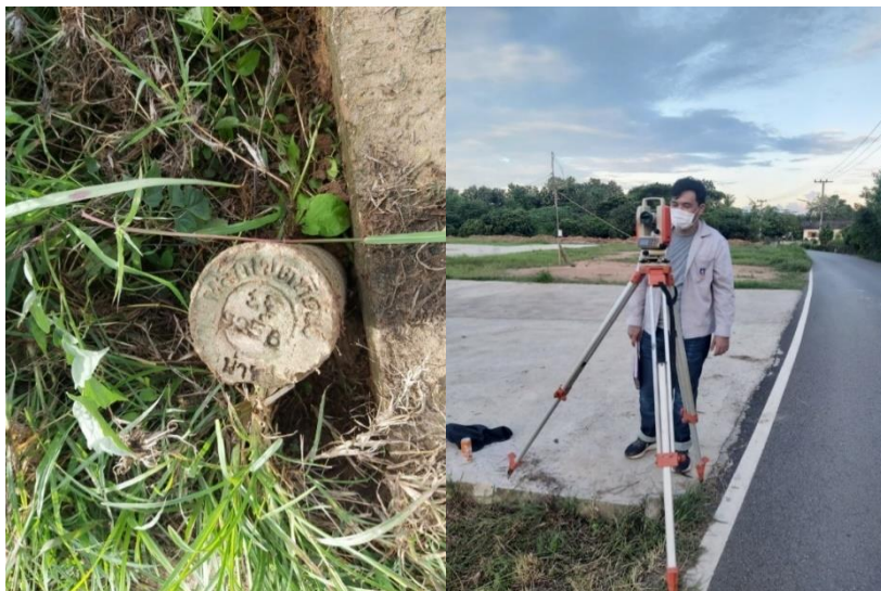
รูปที่ 19 แสดงการถ่ายพิกัดทางราบจากหมุดหลักเขตของกรมที่ดิน
