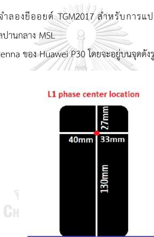
รูปที่ 14 แสดงตำแหน่งของ antenna phase center ของ Huawei P30 (Uradzinski & Bakula, 2020)
