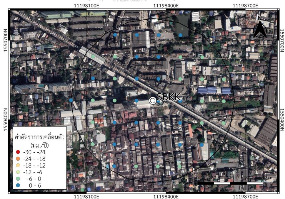
รูปที่ 61 จุดข้อมูลค่าอัตราการเคลื่อนตัวเฉลี่ยของแผ่นดินแบบอนุกรมเวลา (มม./ปี) วงโคจรขาลง สถานี SBKK ในรัศมี 300 ม. บริเวณกรมแผนที่ทหาร ถนนลาดพร้าว เขตวังทองหลาง
