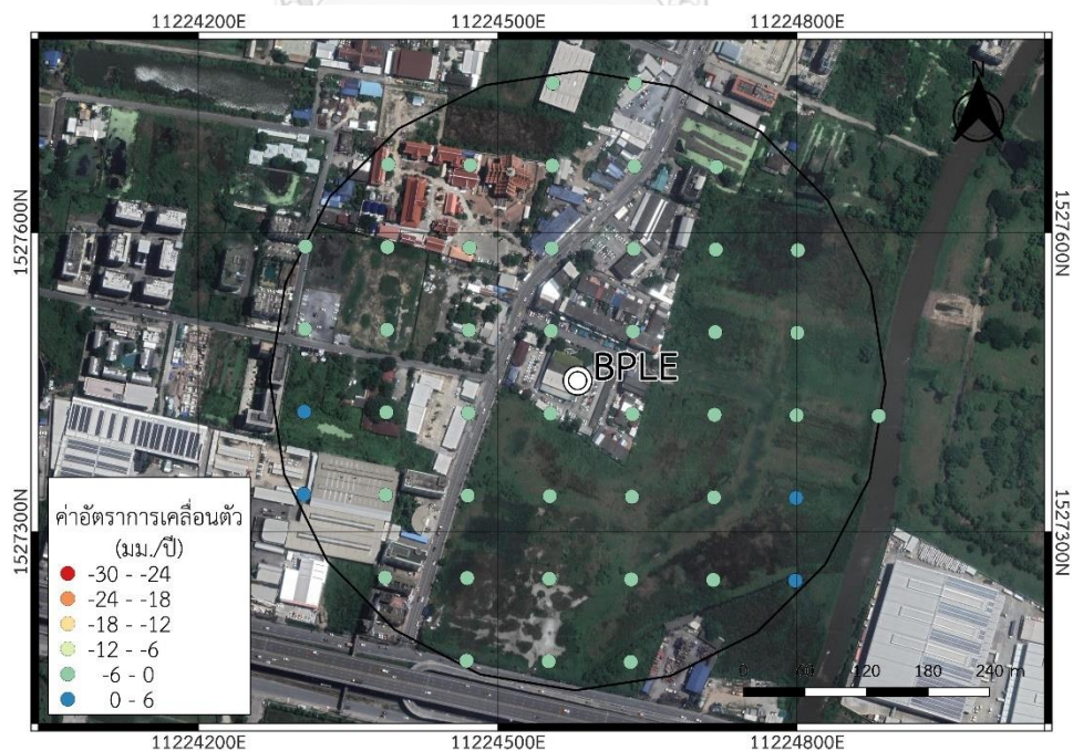
รูปที่ 64 จุดข้อมูลค่าอัตราการเคลื่อนตัวเฉลี่ยของแผ่นดินแบบอนุกรมเวลา (มม./ปี) วงโคจรขาขึ้น สถานี BPLE ในรัศมี 300 ม. บริเวณสำนักงานที่ดินจังหวัดสมุทรปราการ สาขาบางพลี
