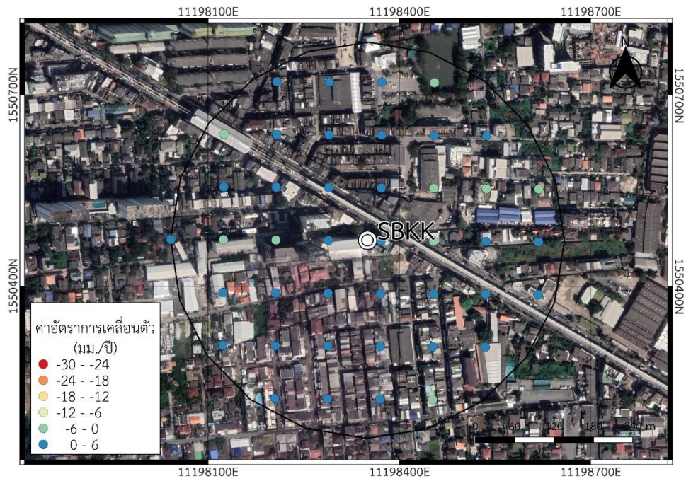
รูปที่ 60 จุดข้อมูลค่าอัตราการเคลื่อนตัวเฉลี่ยของแผ่นดินแบบอนุกรมเวลา (มม./ปี) วงโคจรขาขึ้น สถานี SBKK ในรัศมี 300 ม. บริเวณกรมแผนที่ทหาร ถนนลาดพร้าว เขตวังทองหลาง
