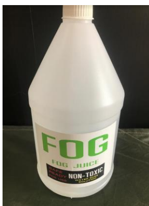
รูปที่ 3.7 น้ำยาสำหรับสร้างควันเพื่อศึกษาการไหลของอากาศผ่านกังหันลมแกนนอนแบบไร้เพลลา
