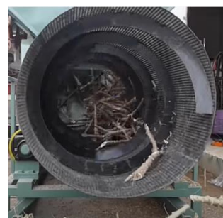
รูปที่ 4.1 การทำงานแบบไร้เพลลาของรถบิ่นแยกกากมันสำปะหลัง
