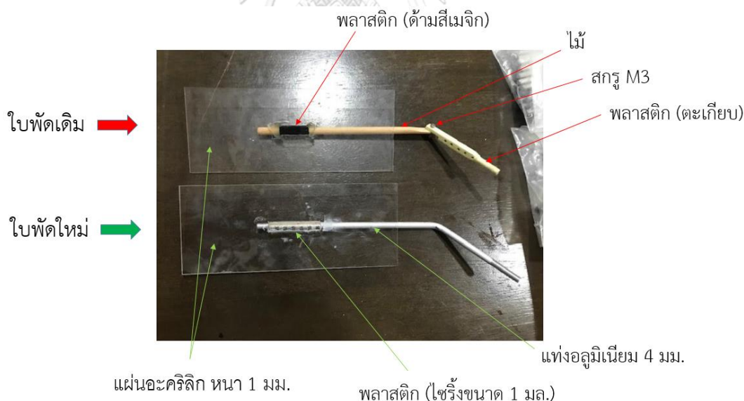
รูปที่ 4.11 การปรับปรุงใบพัดต้นแบบกังหันลมแกนนอนแบบไร้เพลลาสำหรับทดสอบในห้องปฏิบัติการ
