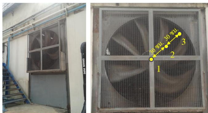
รูปที่ 2.12 ตำแหน่งในการวัดเพื่อศึกษาความเร็วลมที่ออกจากพัดลมระบายอากาศ จุฬาลงกรณ์มหาวิทยาลัย
