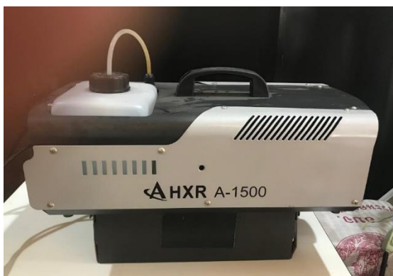
รูปที่ 3.6 เครื่องสร้างควันสำหรับศึกษาการไหลของอากาศผ่านกังหันลมแกนนอนแบบไร้เพลลา
