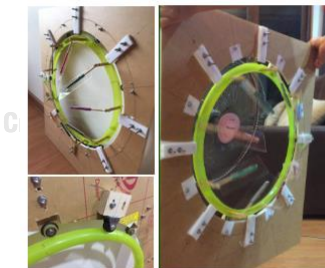
รูปที่ 4.4 Mockup ที่ใช้ทดสอบความเป็นไปได้ของกังหันลมแกนนอนแบบไร้เพลลา สำหรับผลิตไฟฟ้าจากลมระบายอุตสาหกรรม
