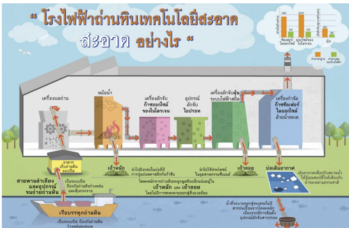
รูปที่ 2 รูปภาพแสดงกระบวนการผลิตโรงไฟฟ้าถ่านหินเทคโนโลยีสะอาด
