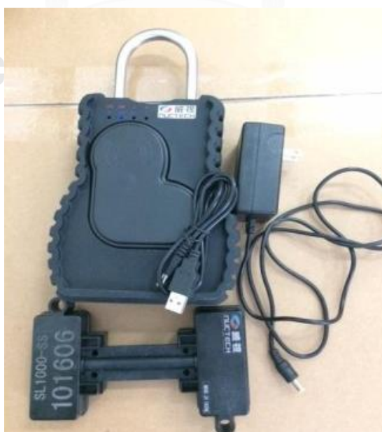
รูปภาพที่ 9 : กุญแจ e - Lock ชนิดแบบ 1 และ 2 ซิมการ์ด
