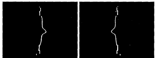
รูปที่ 3 แนวเส้นเลเซอร์บนพื้นผิวชิ้นงานรูปไบหน้าคน จากกล้องตัวซ้ายและขวา
