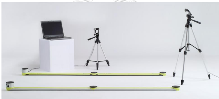
รูปที่ 8 เครื่องทดสอบความสูงในการกระโดด (Optojump) ที่มา : www.optojump.com
