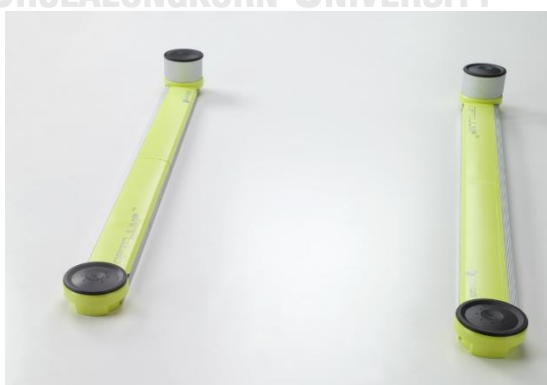
รูปที่ 8 เครื่องทดสอบความสูงในการกระโดด (Optojump) ที่มา : www.optojump.com
