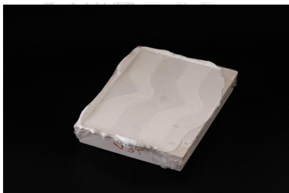
รูป 7. วางแม่พิมพ์ยิปซัมพร้อมกับซิลิโคนอีลาสโตเมอร์ที่อุณหภูมิห้อง
