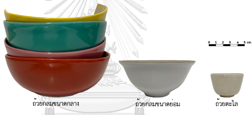
ภาพที่ 3.16 ภาชนะกระเบื้องเคลือบที่ใช้ในการบูรณะซุ้มประตูวัดพระเชตุพนฯ เมื่อปี พ.ศ. 2565 ที่มา: ผู้วิจัย (2565)
