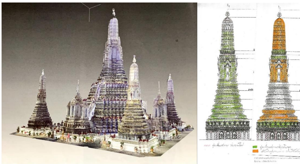
ภาพที่ 1.3 ตัวอย่างการเก็บข้อมูลและการบันทึกสภาพของพระปรางค์วัดอรุณฯ ภาพซ้าย ข้อมูล 3D SCAN พระปรางค์วัดอรุณฯ ภาพขวา การบันทึกความสัมพันธ์สภาพ ปรางค์มุม พระปรางค์วัดอรุณฯ
