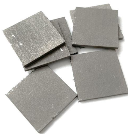
รูปที่ 4.1 ชิ้นงาน Ti-6Al-4V ที่ขึ้นรูปด้วยการพิมพ์สามมิติก่อนเตรียมผิว
