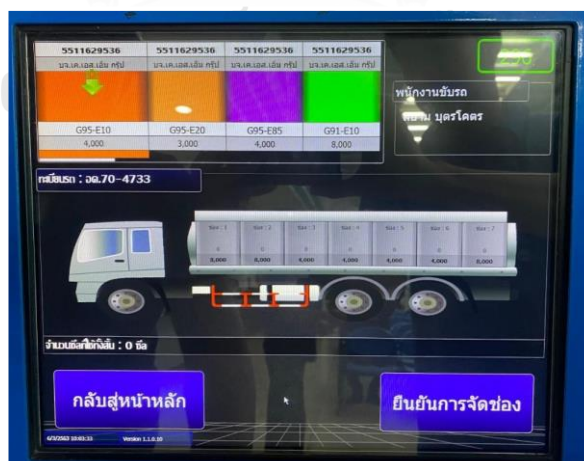
รูปที่ 1.27 การจัดช่องใส่น้ำมันที่ตู้ I-Terminal
