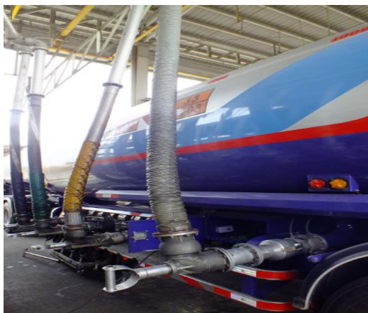
รูปที่ 1.8 หัวจ่ายน้ำมันด้านบนตัวรถบรรทุก (Top Loading)
