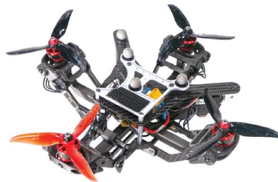
รูปที่ 2.15 อากาศยานไร้คนขับแบบ 4 ใบพัดหมุน ที่ควบคุมทิศทางของแรงใบพัดด้วยการหมุนของมอเตอร์เซอร์โวสองตัวผ่านกลไกเชื่อมต่อแบบพาสซีฟ
