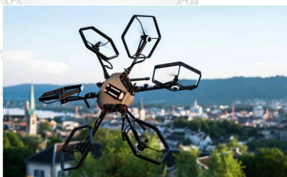
รูปที่ 2.11 อากาศยานไร้คนขับแบบ 6 ใบพัดหมุน ที่ควบคุมทิศทางของแรงใบพัดด้วยการหมุนของมอเตอร์เซอร์โวซึ่งขนานกับแกนของอากาศยาน
