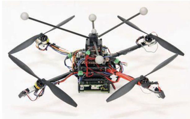
รูปที่ 2.7 อากาศยานไร้คนขับแบบ 4 ใบพัดหมุนที่ควบคุมทิศทางของแรงใบพัดด้วยการหมุนของมอเตอร์เซอร์โว ซึ่งขนานกับแกนของอากาศยาน
