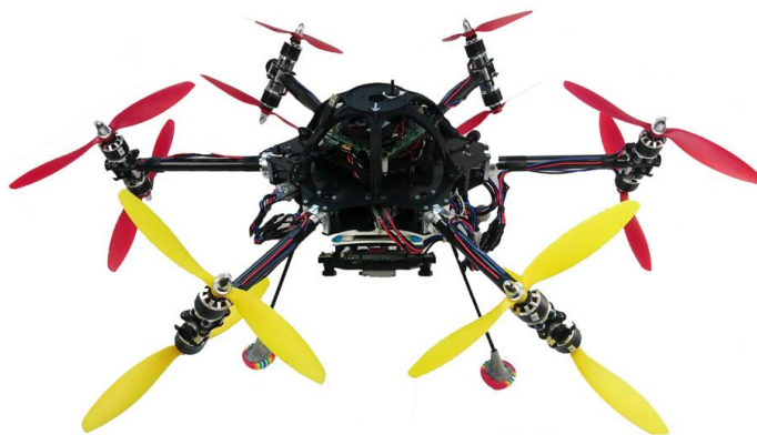
รูปที่ 2.12 อากาศยานไร้คนขับแบบ 6 ใบพัดหมุน แบบโคแอกเซียลที่ควบคุมทิศทางของแรงใบพัด ด้วยการหมุนของมอเตอร์เซอร์โวซึ่งขนานกับแกนของอากาศยาน
