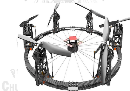
รูปที่ 2.13 อากาศยานไร้คนขับแบบ 6 ใบพัดหมุน ที่ใช้มอเตอร์เซอร์โวเพียงตัวเดียวในการควบคุมทิศทางของแรงใบพัดทั้งหมด
