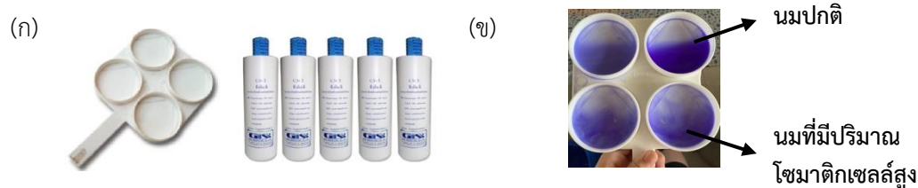
รูปที่ 3.2 (ก) อุปกรณ์ที่ใช้สำหรับการประเมินปริมาณโซมาติกเซลล์ในน้ำนมดิบ
