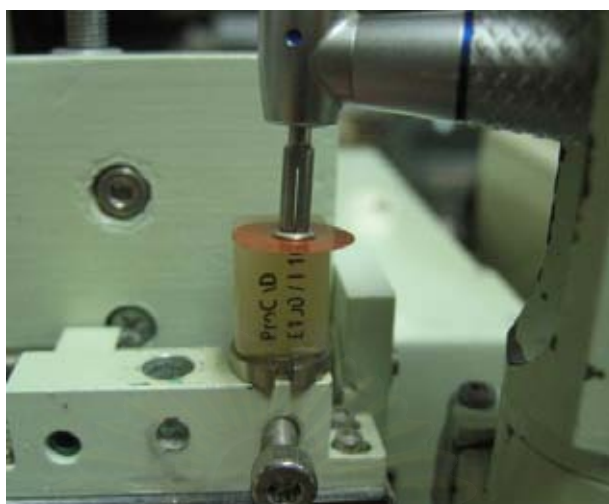
รูปที่ 4 แสดงตัวจับชิ้นงานและการตัดด้วยหัวตัดกระดาด مخروطารูปแผ่นกลมชนิดหยาบ
