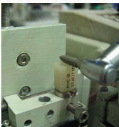
รูปที่ 3 แสดงตัวจับชิ้นงานและการขัดด้วยชุดหัวขัดยางซิลิโคน
