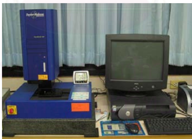
รูปที่ 1 แสดงเครื่องวัดความขรุขระพื้นผิว
