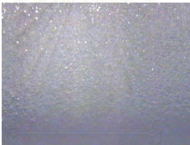
รูปที่ 10 หัวขัดยางซิลิโคนไซฟุความหยาบที่ 1 ที่กำลังขยาย 20 เท่า
