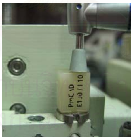
รูปที่ 5 แสดงตัวจับชิ้นงานและการตัดด้วยหัวตัดแอสโทรโพล
