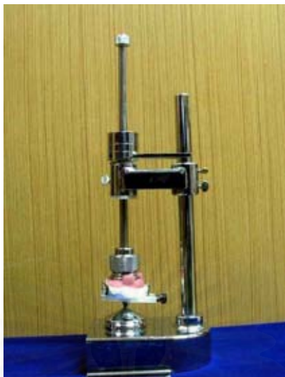
ภาพที่ 44 ภาพขณะทำการทดสอบภาคพิมพ์ปากไร้ฟันต้นแบบ โดยใช้วัสดุพิมพ์ปากอัลจิเนต
