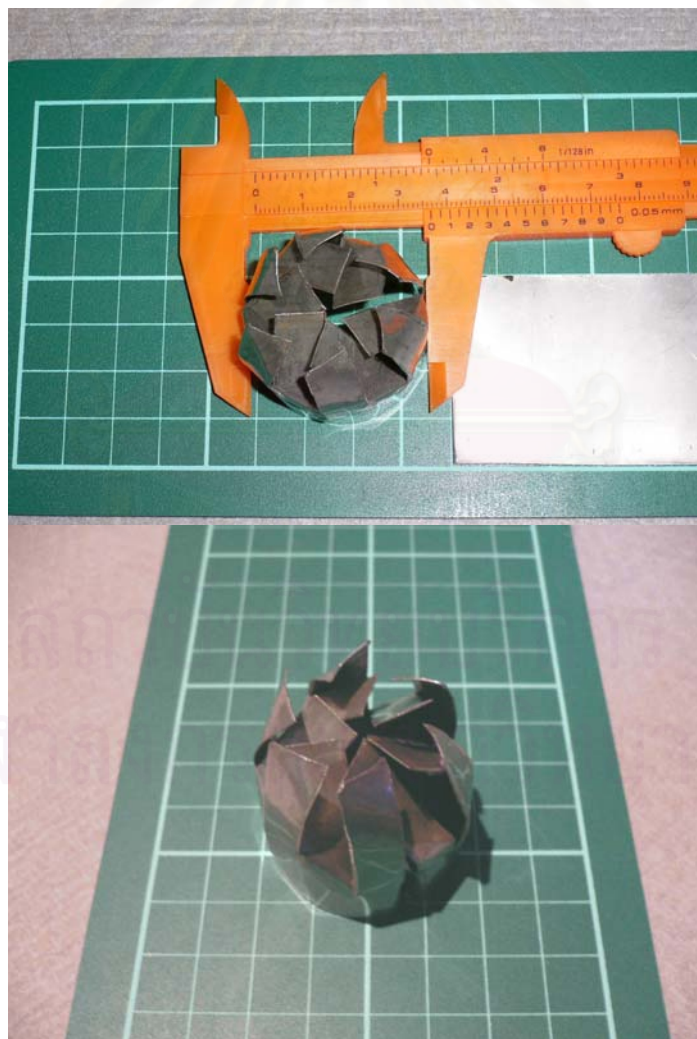
รูปที่ ข.6 static mixer ที่ใช้บรรจุในระบบท่อแนวระนาบ
