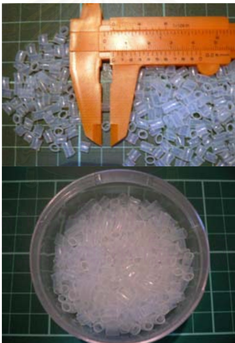
รูปที่ 4.24 ขนาด และลักษณะของท่อ Teflon ที่นำมาใช้เป็น static mixer
