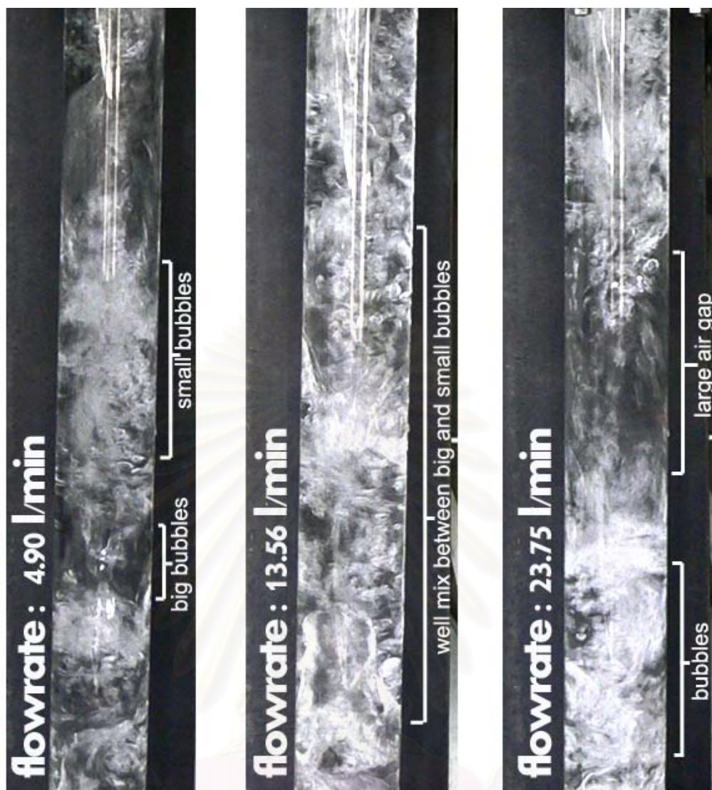
รูปที่ 4.22 ลักษณะการไหลของก๊าซไอโซนในถังปฏิกรณ์ที่อัตราการไหลต่างๆ กัน
