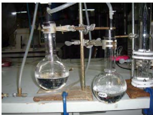
รูปที่ ข.2 ชุดอุปกรณ์วัดปริมาณโอโซนในอากาศ
