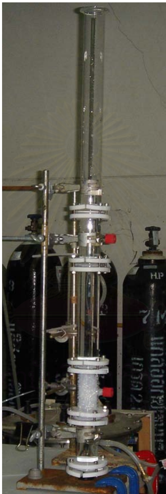
รูปที่ ข.4 ระบบท่อแนวตั้งที่มีการบรรจุ static mixer
